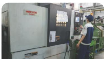
CNC旋盤 - Mori Seiki モデル: NL2500
