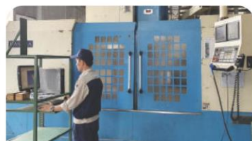
立形マシニングセンター モデル: KASUGA KV1400
