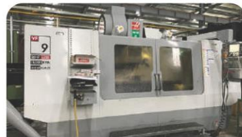
立形マシニングセンター モデル: HASS VF-9
