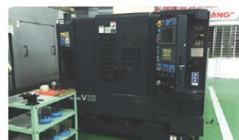
立形マシニングセンター モデル: Makino V33
