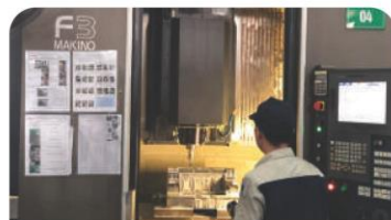
立形マシニングセンター モデル: Makino F3
