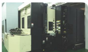
横型マシニングセンター モデル: Makino A77
